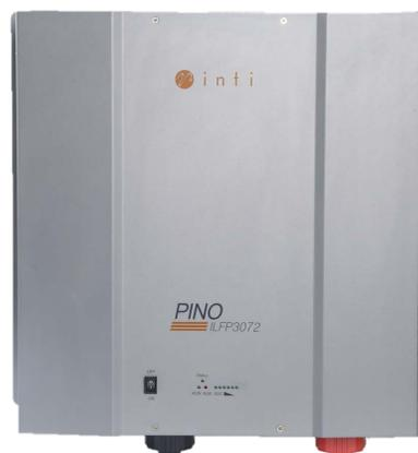
Pino de Inti es una batería Ión Litio libre de mantenimiento LiFePO4 con un rango diverso de capacidades nominales a 25,6Vdc y 51,2Vdc y con una vida útil de  $\geq 3\ 650$  ciclos a un 80% DOD y 25°C. El sistema customizado de carga de la batería con BMS inteligente integrado con protección de temperatura y comunicación tipo RS485 permite extender la vida útil de la batería.
