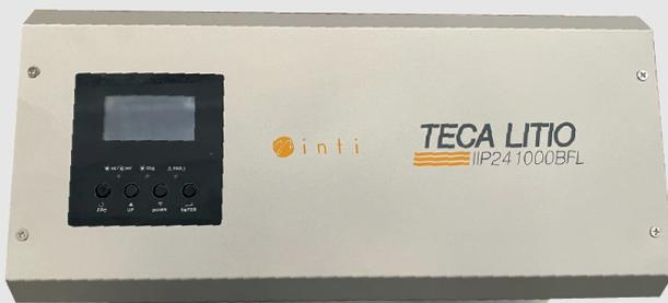
El inverter Teca serie Litio de Inti es un inverter cargador onda pura de baja frecuencia que combina interruptor de transferencia entre batería, inverter y cargador AC compatible con baterías de plomo o de litio a través de comunicación RS485. El inverter puede trabajar con prioridad red o prioridad solar dependiendo de las necesidades de la instalación.
